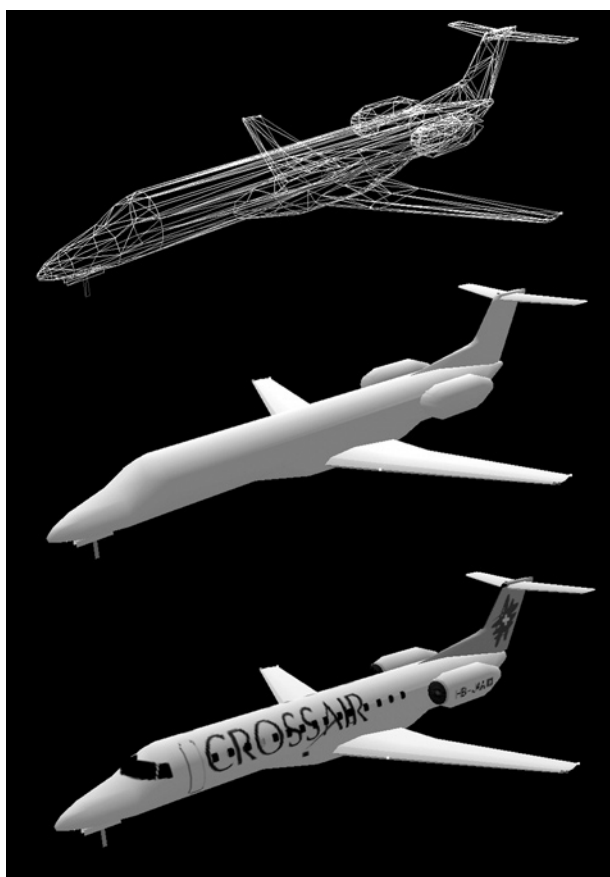
fig. 1 – TROIS REPRÉSENTATIONS DU MÊME MODÈLE: fil de fer, solide, TEXTURÉ
